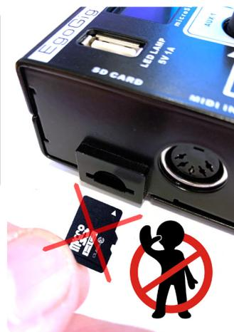
Рис. 1. — Пример **правильной** (слева - «контактами вверх») и неверной (справа — «контактами вниз») **ориентации карты памяти micro SD** в пространстве относительно прибора **AMT EgoGig EG-4**
